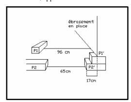
Nommons P1 la pierre de l'ébrasement, P2 la pierre de jambage dont on vient de parler et P1' et P2' pour les pierres correspondantes au côté non effondré de l'encadrement de l'entrée. Entre P2' et P1' il y a environ 17 centimètres de distance. Entre P2' et P2 l'espacement est d'environ 65 centimètres et enfin, entre P1 et P1'la mesure est d'environ 96 centimètres de distance.
